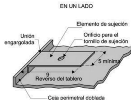
**19.- Abrazadera Galvanizada muestra de herraje tipo abrazadera para montaje de señal en brazo de látigo de semáforo, en forma de omega**
