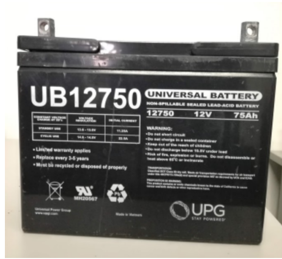
Cuadro 15. Ficha descriptiva Batería sellada AGM 12V 79 AH - (RoHS compliant r) 8A24
